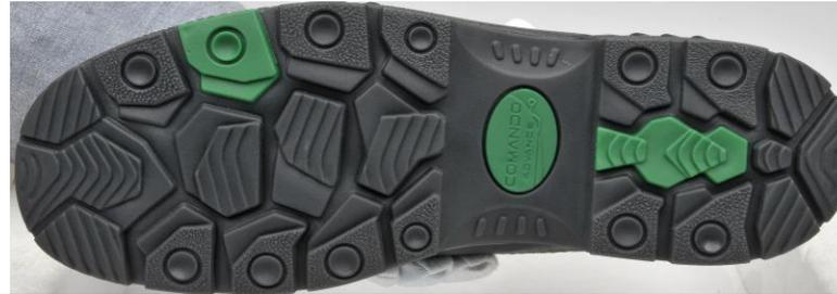
Suela inyectada directa al corte. De PU con patín de TPU. La inyección directa al corte es un proceso de fabricación de alta tecnología, el cual garantiza la unión entre el corte y la suela, supera los estándares de despegado y al ser un proceso automatizado se obtiene un producto de excelente calidad.
